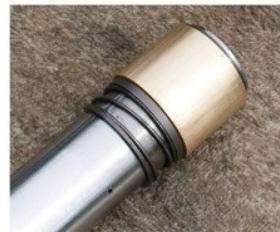
On peut maintenant réintroduire le tube dans le fourreau revisser la bague filetée poser le ressort.
