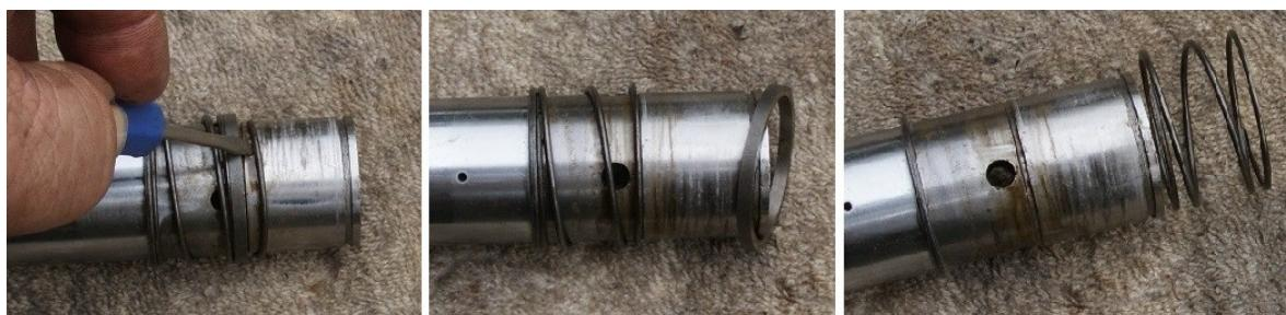
Reste à déposer le dernier circlip
