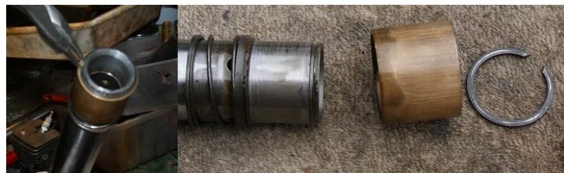
Ôter l'anneau de retenue, la bague d'appui et le ressort
