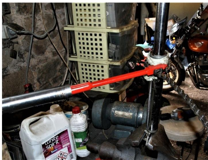
Une fois la bague totalement dévissée on peut sortir le tube du fourreau
