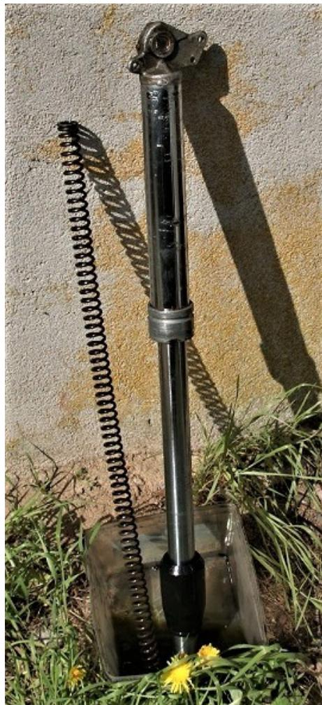
Pour remplacer le joint spi il faut déposer la bague filetée.
