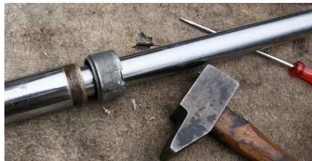
Il ne reste plus qu'à remonter les bras dans les T. Mettre 230 cc d'huile de fourche 5W dans chaque bras, remettre les bouchons enduits d'un produit d'étanchéité du type Loctite moyen ou fort, il est important que ce soit étanche à l'air, éviter le téflon qui se dégrade au contact de l'huile. Serrer enfin les vis de bridage du T inférieur et compléter le serrage des bouchons à environ 35 Nm
